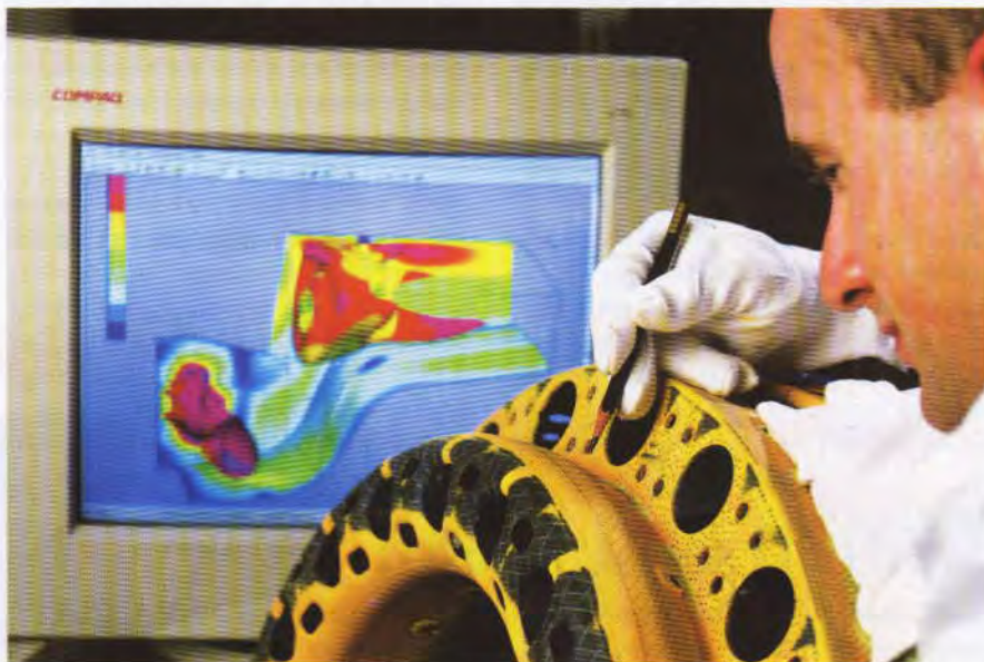
Einsatz von temperatur- und drucksensitiven Farben zur Komponentenanalyse.
